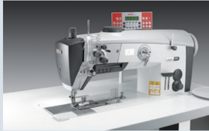
PFAFF 2545 - Einnadel Spezialschnellnäher mit Unter-, alternierendem Ober- und Nadeltransport für Einfassarbeiten
