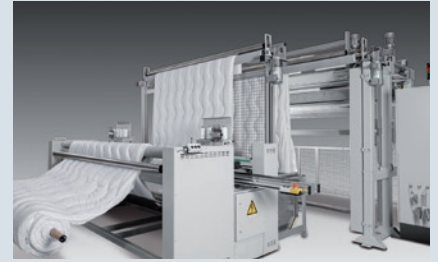
KL 246 - Umsäumanlage (2-Nadel Kettenstich) für die Fertigung von Stepdecken
