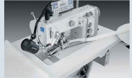
Dürkopp Adler 173 - Einnadel Spezialschnellnäher xxx für Einfassarbeiten (z.B. Matratzenschoner)
