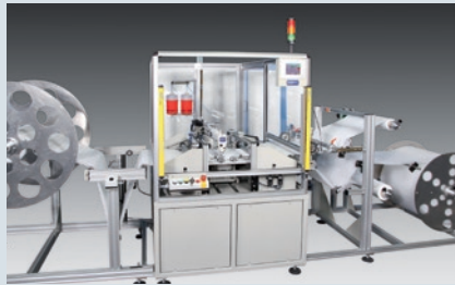
KL 228-2 - Matratzen-Border-Nähautomat zum Absteppen (Wellen, Ecken, Pfeifen)
