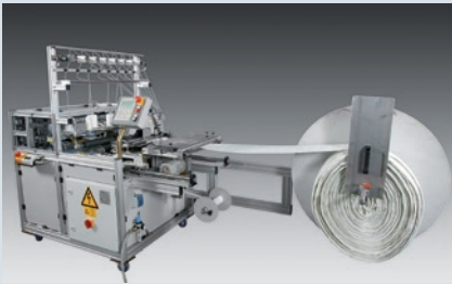
KL 227 - Matratzen-Border-Nähautomat zum Einnähen des Reißverschlusses
