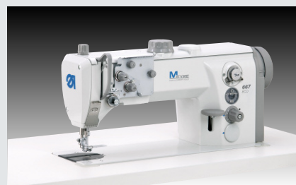
Dürkopp Adler 667 ECO – Einnadel-Flachbettmaschine mit Horizontalgreifer als preislich interessante Einstiegsvariante für universelle Näharbeiten im Wohnpolsterbereich
