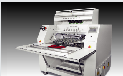
KSL 960 – Vielnadel-Nähanlage mit linearem Nadelantrieb zum geradlinigen Durchnähen von Einzelzuschnitten oder Rollenwaren mit mehreren Nähwerkzeugen in einem Arbeitsgang
