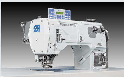
Dürkopp Adler 195-671120-01 – Einnadel-Doppelkettenstichmaschine mit Kantenschneider für den Einsatz im mittelschweren Anwendungsbereich
