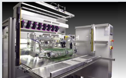
KSL 950 – Vielnadel-Nähanlage zum geradlinigen Durchnähen von Einzelzuschnitten oder Rollenwaren mit mehreren Nähwerkzeugen in einem Arbeitsgang
