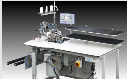
Beisler 1265-5 – Einkopf-Umstechanlage mit differenzierbarem Ober- und Untertransport für Hosen mit/ohne Kniefutter, geeignet für Stretch-Materialien (~ 450 Hosen, 8 Nähte, mit Kniefutter in 480')
