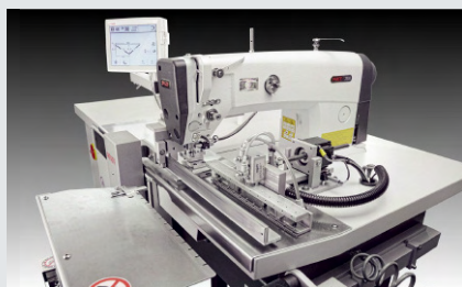
PFAFF 3586-22/02 – CNC-gesteuerte Nähanlage für Abnäher und Bundfalten mit Heftstich, Doppelstepstich (~ 5.500 Abnäher in 480')
