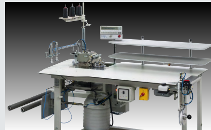
Beisler 1225-6 – Einkopf-Umstechanlage mit differenzierbarem Untertransport für Hosen mit/ohne Kniefutter (~ 450 Hosen, 8 Nähte, mit Kniefutter in 480')
