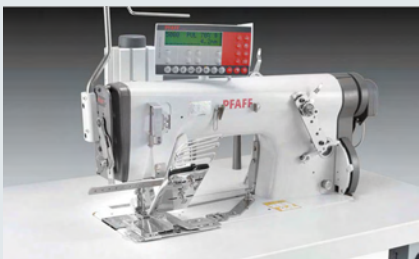
PFAFF 5483-814/01-948/26...-59/03 – Einnadel-Doppelkettenstichmaschine mit Untertransport und Walzen-Obertransport und Führungsapparat für Bund und Bundfutter (~ 1.600 Bunde in 480')
