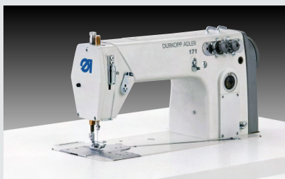
Dürkopp Adler 171-131610 – Ein- oder Zweinadel-Doppelkettenstichmaschine mit Untertransport und Tandem-Gelenkfuß zum Schließen der Gesäßnaht (~ 700 Gesäßnähte in 480')
