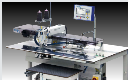
Beisler 1931-5 – Nähanlage zum automatischen Absteppen der linken Schlitzleiste mit Einfach- oder paralleler Doppelnah ( ~ 1.600 gebügelte Schlitzleisten, Doppelnah, in 480')
