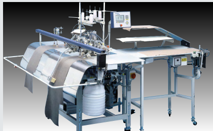
Beisler 1365-5-2 – Zwei-/Dreikopf-Umstechanlage mit differenzierbarem Ober- und Untertransport für Hosen mit/ohne Kniefutter, geeignet für Stretch-Materialien (~ 700 Hosen, 8 Nähte, mit Kniefutter in 480')
