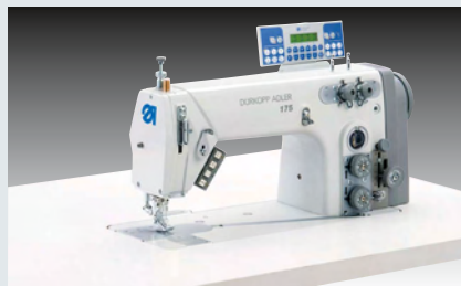
Dürkopp Adler 175-141621 – Zweinadel-Doppelkettenstichmaschine mit differenzierbarem Obertransport für Mehrweite im Reißverschluss, Bandabzugsggerät, optional (~ 4.000 Schlitzleisten in 480')
