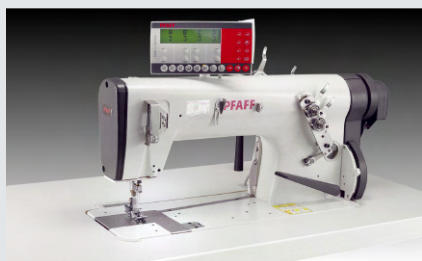
PFAFF 5483-H-814/01-6/10 – Ein- oder Zweinadel-Doppelkettenstichmaschine mit Untertransport, Tandem-Gelenkfuß und Rückwärtsstich-Einrichtung zum Schließen der Gesäßnaht (~ 1.000 Gesäßnähte in 480')
