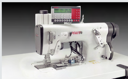
PFAFF 5483-814/01-948/26 – Gestalteter Arbeitsplatz mit Puller, pneumatischem Kantenanschlag zum Schließen der Seiten- und Schrittnähte, Doppelkettenstich (~ 350 – 400 Hosen, 4 Nähte, in 480')
