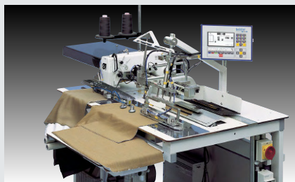
Beisler 2211-5 – Nähanlage zum Umbiegen, Vornähen und Einschneiden der linken Schlitzleiste, optional zum Annähen der rechte Schlitzleiste, Doppelsteppstich (~ 1.000 Hosen, r/l Schlitzleiste nähen in 480')
