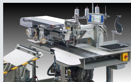
Dürkopp Adler 755 A – Nähanlage für gerade Paspel- und Leistentaschen mit/ohne Patte, mit programmierbarem Nadeltransport und manueller Zuführung (~ 1.600 – 2.600 Taschen in 480')
