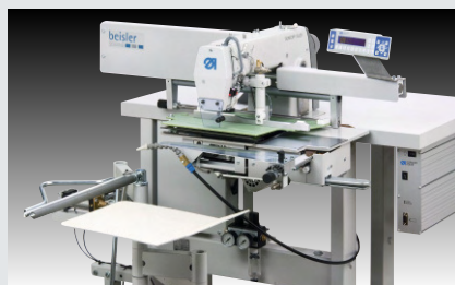
Beisler 743-121-01 – Nähanlage für Abnäher und Bundfalten, Doppelkettenstich (~ 6.500 – 7.000 Abnäher in 480')
