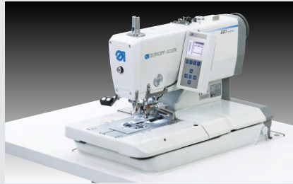
Dürkopp Adler 581-341 – CNC gesteuerter Augenknopflochautomat mit Multiflex-Schneidsystem, Kurzfadenschneider und Gimpe für Freizeituhosen (~ 800 Hosen, bei 3 Knopflöchern, in 480')
