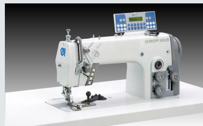
Dürkopp Adler 275-140342-01 (550-2-1) – Doppelsteppstichmaschine mit differenzierbarem Obertransport + Faltapparat zum Ankappen der linken Schlitzleiste (~ 500 – 600 Hosen, r/l Schlitzleiste, in 480')
