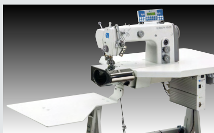
Dürkopp Adler 550-5-5-2 – Gestalteter Arbeitsplatz mit Doppelstepstichmaschine, Puller und Nadeltransport zum Absteppen des Bundes im Nahtschatten oder auf dem Bund (~ 550 Hosen in 480')
