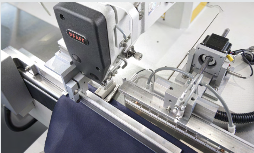
Nähanlagen zum Vornähen von Paspel-, Patten- und Leistentaschen Sewing units for runstitching of piped pockets, flap pockets and welt pockets
