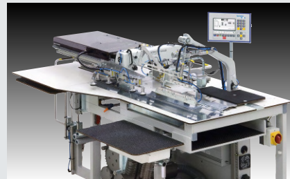
Beisler 2112-5 – Nähanlage zum Umbiegen, Vornähen und Einschneiden von Flügeltaschen, Taschenbesetzen/Schlitzleisten aufnähen, Doppelsteppstich (~ 800 Hosen, = 1.600 Tascheneingriffe, in 480')
