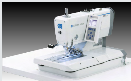
Dürkopp Adler 581-112 – CNC gesteuerter Augenknopflochautomat mit Kurzfadenschnittr ohne Gimpe für klassische Hosen (~ 800 Hosen, bei 3 Knopflöchern, in 480')
