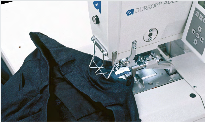
Näutomaten für das Annähen von Knöpfen Sewing automats for the attaching of buttons
