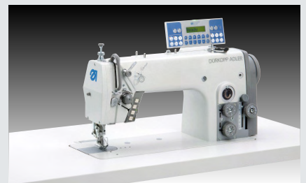
Dürkopp Adler 275-140342-01 – Einnadel-Doppelsteppstichmaschine mit Unter- und differenz. Obertransport zum Absteppen der linken Schlitzleiste (~ 1.100 – 1.250 gebügelte Schlitzleisten in 480')
