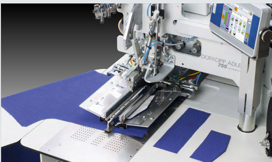
Nähanlagen zum Vornähen von Paspel-, Patten- und Leistentaschen Sewing units for runstitching of piped pockets, flap pockets and welt pockets
