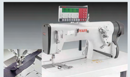
PFAFF 5483-814/06-94/01 – Zweinadel-Kettenstichschnellnäher mit Untertransport und optionalem Reißverschlussapparat (~ 3.000 Schlitzleisten in 480')
