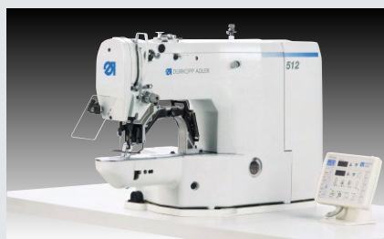
Dürkopp Adler 512-211-01 – CNC gesteuerter Doppelsteppstich-Riegelautomat, mit optional erhältlichen Bausatz für mittelschwere bis schwere Anwendungen
