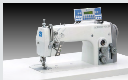
Dürkopp Adler 275-140342-01 – Einnadel-Doppelstepstichmaschine mit differenzierbarem Fuß-Obertransport, zum Futter an Besetzen nähen, dabei Paspelband mitfassen (~ 300 – 350 Besetzen in 480')
