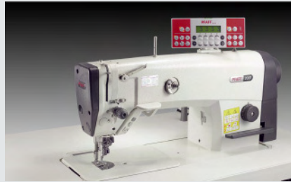
PFAFF 2081-731 – Einnadel-Doppelsteppstichmaschine mit Nadeltransport zum Vornähen und Beschneiden von Spitzfassons durch manuelle Schablonenführung (~ 900 Spitzfassons in 480')
