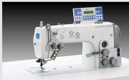
Dürkopp Adler 272-160362-01 – Einnadel-Doppelstepstichmaschine mit Nadeltransport, 6 mm Stichlänge und Stichlockerung zum Zuheften des Tascheneingriffes (~ 750 Paspeltaschen in 480')
