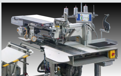
Dürkopp Adler 756 A – Nähanlage mit manueller Zuführung und Brustleistenklammer für Brustleistentaschen (~ 700 – 750 Taschen in 480')
