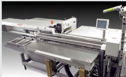
PFAFF 3519-5/01 – Einnadel-Doppelstepstich-Nähautomat für ein- und zweispitzige Abnäher, 80 – 395 mm Abnäherlänge (~ 2.400 zweispitzige Abnäher in 480')
