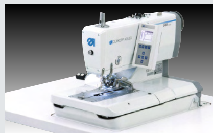
Dürkopp Adler 581-151 – CNC gesteuerter Augenknopflochautomat mit manuellem Fadenabschneider und Gimpe für Sakkos und Blazer
