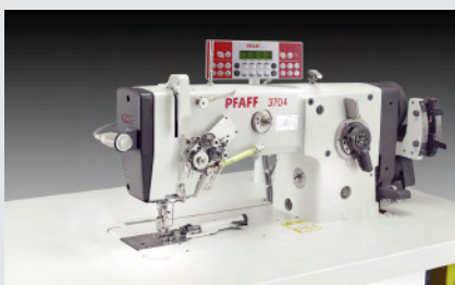
PFAFF 3704-2/02 – Optimierter Arbeitsplatz mit differenzierbarem Untertransport zum Annähen des Filzkragens an den Oberkragen (~ 1.600 Kragen in 480')
