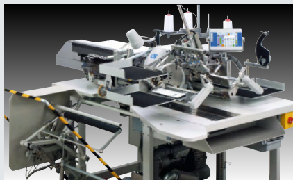
Dürkopp Adler 745-35-10 F – Nähanlage für gerade oder schräge Paspel- und Leistentaschen mit und ohne Patte, mit automatischer Zuführung und Abrichtvorrichtung für Karo und Streifen (~ 1.700 – 1.800 Taschen in 480')
