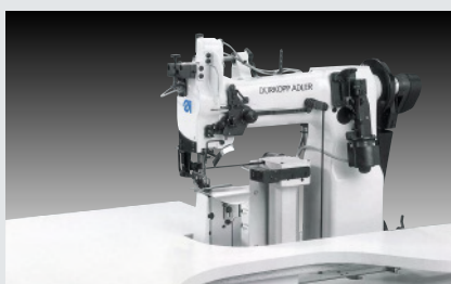
Dürkopp Adler 697-15155 – Optimierter Arbeitsplatz zum Einnähen des Ärmelfutters mit Nadel-, alternierendem Obertransport, Mehrweite und automatischer Stichlockerung (~ 180 Paar Ärmelfutter in 480')
