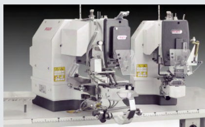
PFAFF 3307-1/13 + 3307-9/02 – CNC-gesteuerter Einfadenkettenstich-Knopfannähsautomat und Stielumwickler in V-Aufstellung
