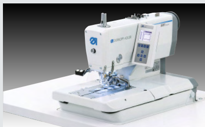
Dürkopp Adler 581-112 – CNC gesteuerter Doppelkettenstich-Knopflochautomat mit Kurzfadensabschneider ohne Gimpe (~ 2.000 Futterdreiecke in 480')
