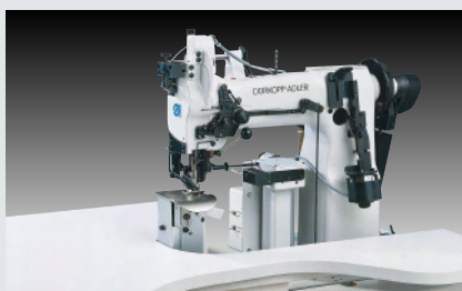
Dürkopp Adler 697-24155 – Optimierter Arbeitsplatz zum Ausfertigen und Beschneiden des Armlochs mit Nadel-, alternierendem Obertransport, Mehrweite und automatischer Stichlockerung (~ 300 Leibfutter in 480')
