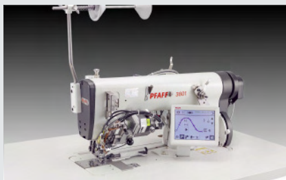
PFAFF 3801-11/07 – Optimierter Arbeitsplatz für Lisierarbeiten bzw. zum Vorkräuseln der Armkugel (~ 450 Paar Armlöcher in 480')
