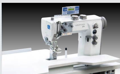
Dürkopp Adler 670 – Einnähen des Ärmelfutters mit Nadel- und altern. Obertransport; max. Stichlänge 9 mm; elektr. Funktionen wie Stichlockerung, Mehrweite, 2. Hub und 2. Stichlänge (~ 200 Paar Ärmelfutter in 480')
