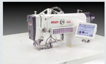
PFAFF 3822-2/42 – Einnadel-Doppelsteppstichmaschine mit differenzierbarem Fuß-Obertransport, Kantenschneider und Mehrweitensteuerung (~ 270 Sakkos in 480')
