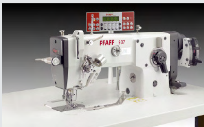
PFAFF 937-32/23 – Einnadel-Doppelsteppstichmaschine mit Zickzack-Stich und differenzierbarem Obertransport zum Annähen des Kragens (~ 500 – 550 Kragen in 480')
