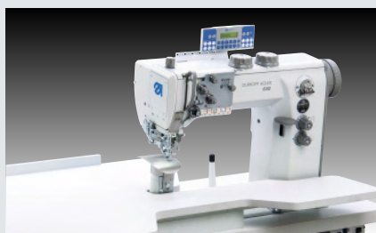
Dürkopp Adler 680 – Ausfertigen + Beschneiden der Armlöcher mit Nadel- und altern. Obertransport; max. Stichlänge 9 mm; elektr. Funktionen wie Stichlockerung, Mehrweite, 2. Hub und 2. Stichlänge (~ 340 Leibfutter in 480')
