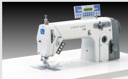
Dürkopp Adler 179-171629 – Einfaden-Kettenstichmaschine mit Unter- und differenzierbarem Fuß-Obertransport für Heftarbeiten
