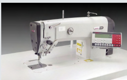
PFAFF 2483 – Einnadel-Doppelstepstichmaschine mit Untertransport und Sensorik zur Erkennung der Stofflagen mit automatischem Setzen des Eckstichs (~ 1.200 Etiketten in 480°)
