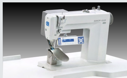
Dürkopp Adler 650-10 OP3000 – Optimierter Arbeitsplatz zum Einnähen von Ärmeln mit „Kurvenunterstützung“ (~ 220 Sakkos in 480', Ärmel vorgekräuselt)
