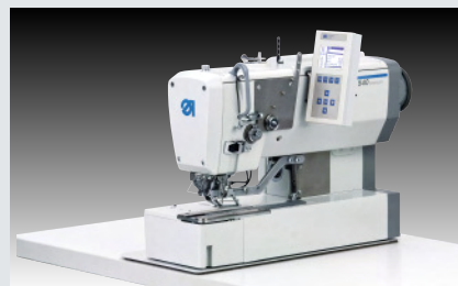
Dürkopp Adler 540-100-01 – CNC gesteuerter Doppelstepstich-Knopflochautomat (~ 2.400 Futterdreiecke in 480')
