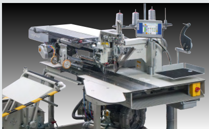
Dürkopp Adler 755 A – Nähanlage für gerade Paspel- und Leistentaschen mit/ohne Patte, mit programmierbarem Nadeltransport und manueller Zuführung (~ 1.300 – 1.600 Taschen in 480')
