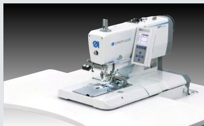
Dürkopp Adler 581-321 – CNC gesteuerter Augenknopflochautomat mit Multiflex-Schneidsystem und Langfadenabschneider und Gimpe für Sakkos
