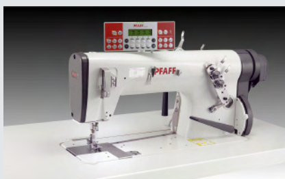
PFAFF 5483-814/01 – Einnadel-Doppelkettenstichmaschine mit Untertransport zum Futter an Besetzen nähen (~ 300 – 350 Besetzen in 480')
