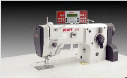
PFAFF 918 – Einnadel-Doppelstepstichmaschine mit Zickzack-Stich und Untertransport zum Ausfertigen vom Plack
