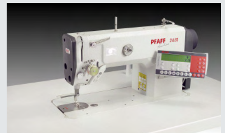
PFAFF 2481-906/11 – Einnadel-Doppelstepstichmaschine mit Nadeltransport, 6 mm Stichlänge und Stichlockerung zum Zuheften des Tascheneingriffes (~ 750 Paspeltaschen in 480')
