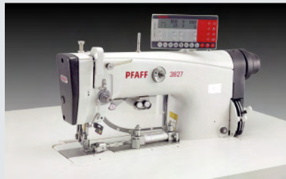
PFAFF 3827-4/34 – Einnadel-Doppelsteppstichmaschine mit differenzierbarem Fuß-Obertransport und zwei unterschiedlichen Mehrweiten (~ 300 – 310 Seiten- und Schulternähte in 480')
