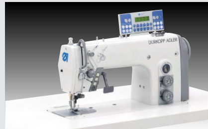
Dürkopp Adler 272-640642-01 – Einnadel-Doppelstepstichmaschine mit Nadeltransport zum Nähen und gleichzeitigem Beschneiden von Abnähern (~ 600 Abnäher in 480')
