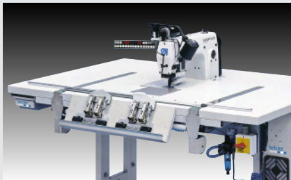
Beisler 739-23-1 – CNC-gesteuerte Nähanlage mit Doppelsteppstich zum Vornähen und Beschneiden von Kleinteilen wie z. B. Patten etc. (~ 2.000 – 2.200 Patten in 480')
