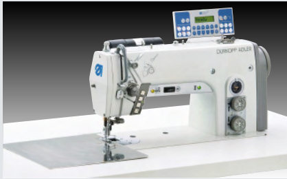
Dürkopp Adler 272-740642-01 (E114) – Einnadel-Doppelsteppstichmaschine mit Nadeltransport zum Vornähen und Beschneiden von Spitzfassons durch manuelle Schablonenführung (~ 900 Spitzfassons in 480')
