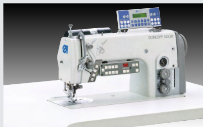
Dürkopp Adler 275-742642-01 – Einnadel-Doppelsteppstichmaschine mit differenzierbarem Fuß-Obertransport, Kantenschneider und bis zu 8 unterschiedlich Mehrweiten (~ 200 Sakkos in 480')
