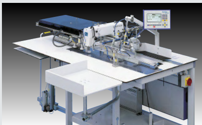
Beisler 2111-5 – Einnadel-Doppelsteppstich-Nähanlage zum automatischen Umbiegen und Aufnähen von geraden Taschenbesetzen (~ 4.000 Taschenbesetzen in 480')
