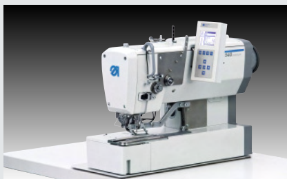
Dürkopp Adler 540-500-01 – CNC gesteuerter Doppelstepstich-Knopflochautomat mit separat angetriebenem Messer für verlängertes Schneiden bis zum Knopflochriegel (~ 2.400 Futterdreiecke in 480')
