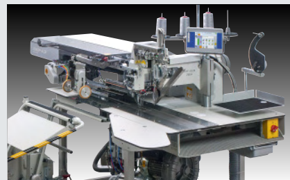
Dürkopp Adler 756 A – Nähanlage für gerade oder schräge Paspel- und Leistentaschen mit/ohne Patte, mit programmierbarem Nadeltransport und manueller Zuführung (~ 1.300 – 1.600 Taschen in 480')
