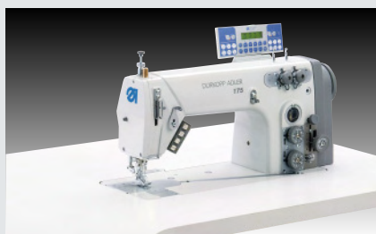
Dürkopp Adler 175-141621 – Einnadel-Doppelkettenstichmaschine mit differenzierbarem Fuß-Obertransport – Futter an Besetzen nähen, dabei Paspelband mitfassen (~ 300 – 350 Besetzen in 480')
