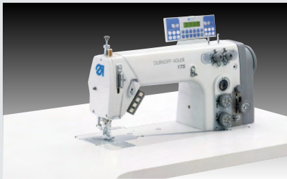
Dürkopp Adler 175-141621 – Einnadel-Doppelkettenstichmaschine mit Unter- und differenzierbarem Fuß-Obertransport
