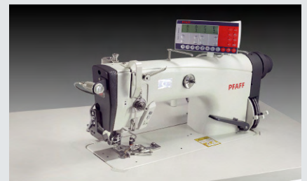
PFAFF 487-19/19 – Einnadel-Doppelsteppstichmaschine mit differenzierbarem Obertransport – eine voreingestellte Mehrweite über Taster abrufbar (~ 830 Hemdensäume in 480')
