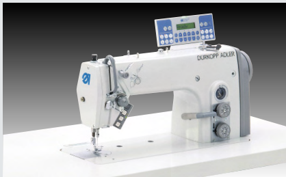
Dürkopp Adler 272-140342-01 (E75) – Einnadel-Doppelstepstichmaschine mit Unter- und Nadeltransport zum Ärmelennähen und Übersteppen (~ 220 Hemden in 480')
