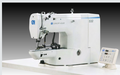
Dürkopp Adler 532-211-01 – CNC gesteuerter Doppelstepstich-Knopfannähschneidemaschine (~ 900 Hemden mit 7 Knöpfen auf der Leiste)
