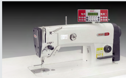
PFAFF 2083 – Einnadel-Doppelstepstichmaschine mit Untertransport zum Ärmelennähen (~ 420 Hemden in 480')
