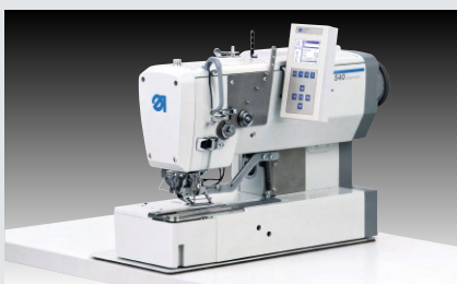
Dürkopp Adler 540-500-01 – CNC gesteuerter Doppelstepstich-Knopflochautomat mit separat angetriebenem Messer für verlängertes Schneiden bis zum Knopflochriegel (~ 4.000 Stiche/Min.)
