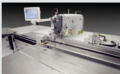
PFAFF 3586-25/01 – CNC-gesteuerter Doppelstepstich Nähautomat für Abnäher bis zu 490 mm Abnäherlänge, z. B. bei Slimline-Hemden (~ 2.700 zweispitzige Abnäher in 480')
