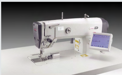
PFAFF 2481 – Einnadel-Doppelstepstichmaschine mit Unter-, Nadeltransport und Sensorik zur Erkennung der Stoffkanten mit automatischem Setzen des Eckstichs (~ 1.600 Kragen in 480')
