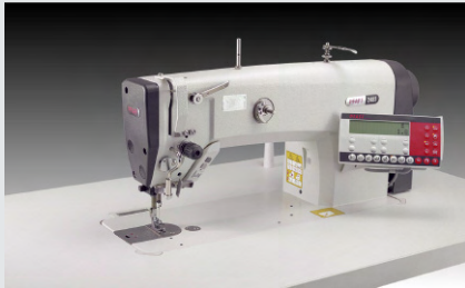
PFAFF 2483 – Einnadel-Doppelstepstichmaschine mit Untertransport und Sensorik zur Erkennung der Stofflagen mit automatischem Setzen des Eckstichs (~ 1.400 Etiketten in 480')
